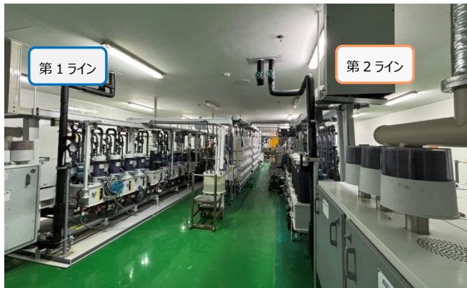
現像・エッチング・剥離ライン
